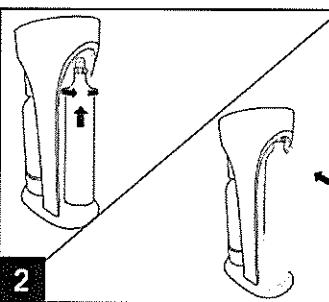
ガスシリンダーの口金を本体裏上部のシリンダー装着部分にあて、左に回してしっかりとシリンダーを装着してください。
