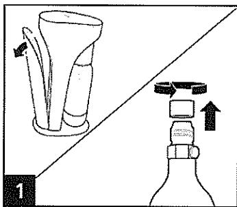
背面カバーを取り外し、本体上部の炭酸ガスシリンダー装着部の保護カバーを取り外してください。
