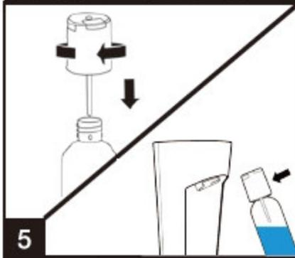
ボトルにインフューザーを差し込み、上から軽く押しながら右に回して取り付けます。
