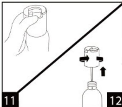
シューと言うガスが出る音が止まったら、ブルーのフルリリースタブを押し、ボトル内のガスが完全に抜けたかどうか確認してください。
