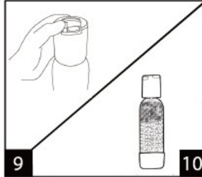
ボトル内のガス抜きをします。ボトルを平らな場所に置き、銀色のスローリリースタブを開けます。
