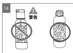
できあがった炭酸水はインフューザーをふた代わりにせずにボトルキャップをしっかりとはめて冷蔵庫で保管してください。インフューザーをふたの代わりにするとボトル内の内圧により飛び出しがあります。
