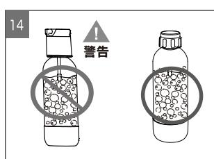
**警告** できあがった炭酸飲料はインフューザーをふた代わりにせずにボトルキャップをしっかりとはめて冷蔵庫で保管してください。インフューザーをふたの代わりにするとボトル内の内圧により飛ぶ可能性があります。
