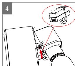
マシンヘッドの下のレバーを引きながら引っ張ると本体内部のパーツが外れます。
